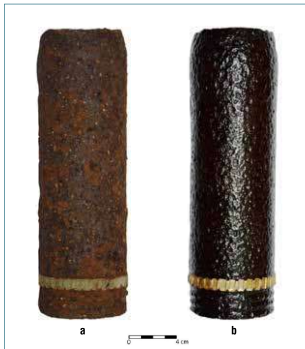
Ryc. 11. Kadłub niemieckiego szrapnela artyleryjskiego 7,7 cm F.Schr.96 n/A: a – przed konserwacją, b – po konserwacji (nr inw. APP-19-(W1)-Ob2-Zb).
