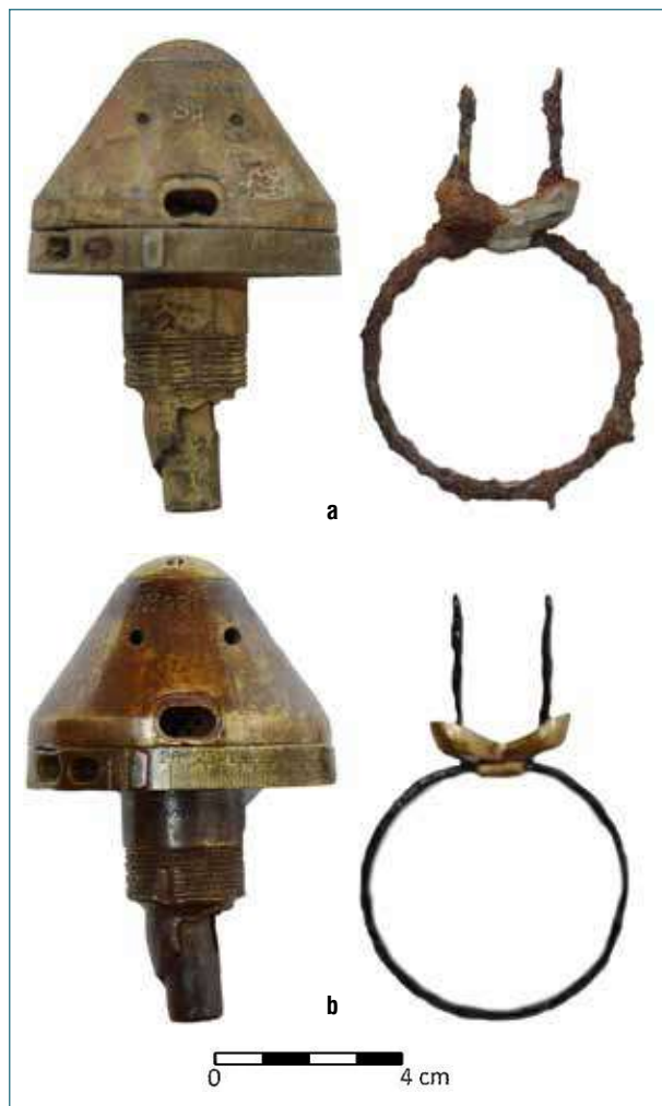
Ryc. 19. Destrakt niemieckiego zapalnika artyleryjskiego Dopp.Z.92. f. 10 cm K. oraz zawleczka zabezpieczająca: a – przed konserwacją, b – po konserwacji (nr inw. APP-5-ZN-N003, APP-5D-(W7)-Z458, APP-12-(W1)-Z087).
