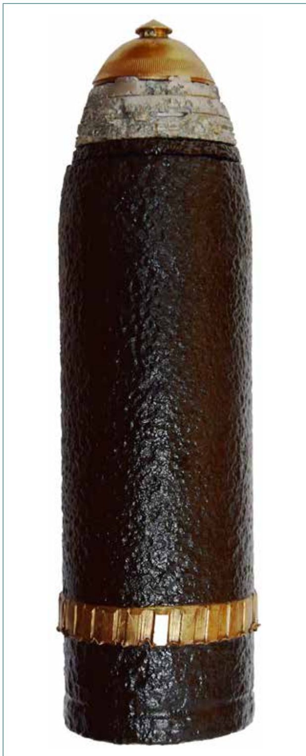
Ryc. 1. Destrukt rosyjskiego 3-calowego szrapnela: kadłub pocisku z wkrętką głowicową i zapalnikiem artyleryjskim 22.П. (nr inw. BP-(60-59)-ZN-A313, APP- 5d-BP-ZN-D086/2, APP-3-(W1)-Z088, APP-12-(W1)-Z024; wszystkie ryciny w tym rozdziale: konserwacja, rekonstrukcja i zdjęcia K. Karasiewicz).
