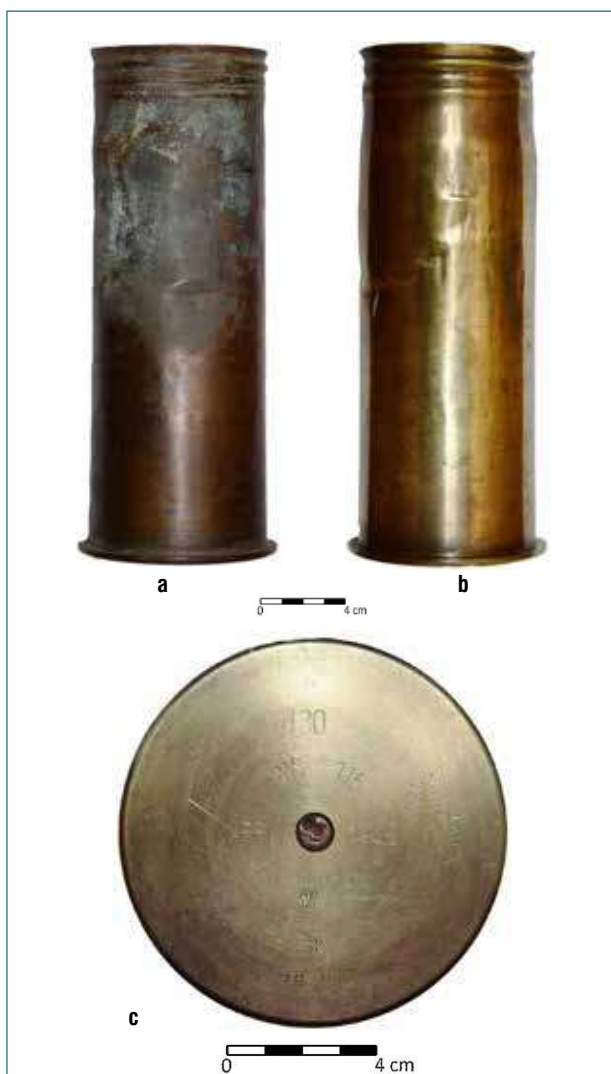
Ryc. 16. Łuska artyleryjska niemieckiego naboju 7,7 cm × 22,8 R: a – przed konserwacją, b – po konserwacji, c – przykład znakowania dna łuski (nr inw. APP-18-(DAR)-PK-3).
