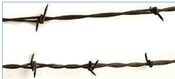
Ryc. 1. Drut kolczasty dwukolcowy. Drut górny ma rozstaw kolców około 10 cm i jest typowym drutem rolniczym, drut dolny ma rozstaw około 5 cm i może być wykorzystywany do budowy fortyfikacji polowych (Źródło: https://bantjes.com/barbed-wire/ ).
